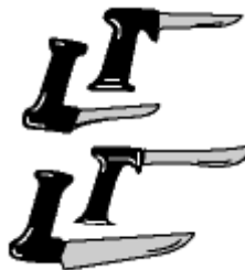
Figure 10 - Manches de couteau qui éliminent la nécessité de plier le poignet lors du découpage
