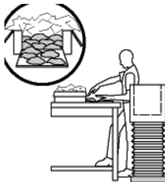
Figure 12 - Couper un côté de la boîte élimine la nécessité de plier le poignet
