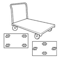
• Utiliser une plate-forme à roues à timon détachable pour transporter ce qui doit être entreposé temporairement.
